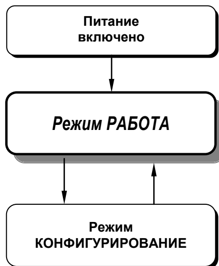
Рисунок 6.1 - Диаграмма режимов работы, защиты и настроек индикаторов ИТМ-11, ИТМ-11В
