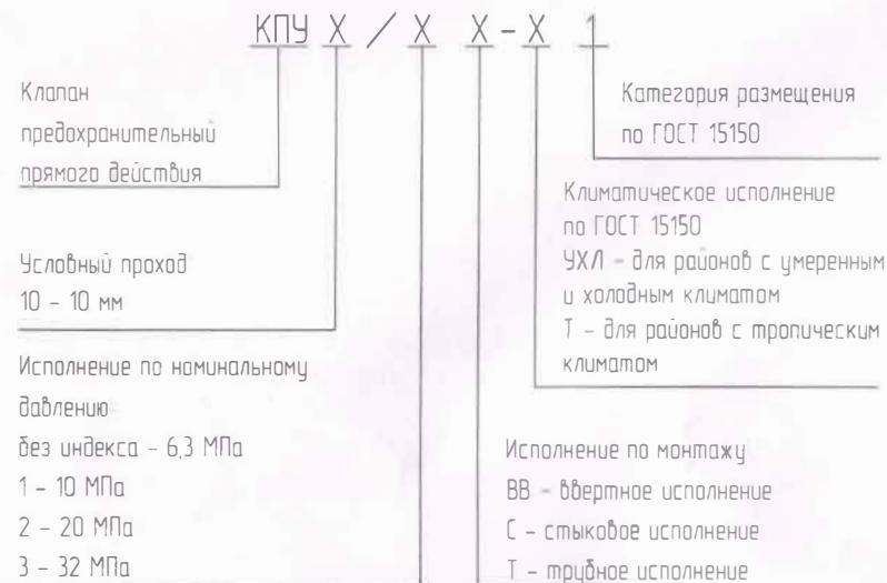
Рисунок 1.1 Условное обозначение гидроклапана предохранительного
