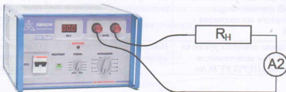
Рисунок 5 – Схема калибровки амперметра Генератора
