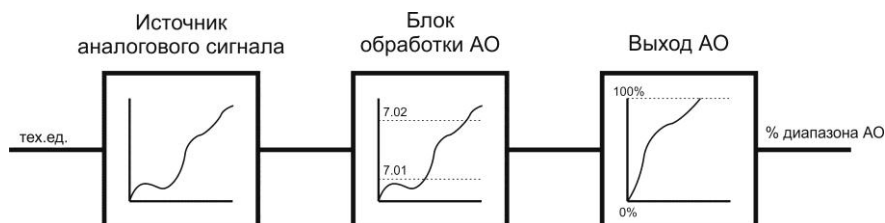
Рисунок 3.6 – Работа блока аналогового вывода в режиме ретрансмиссии
