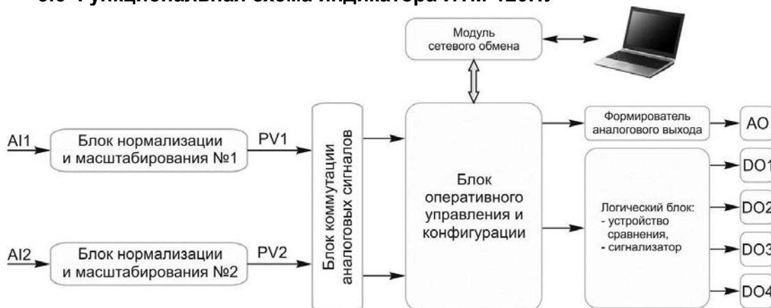
Рисунок 3.3 - Функциональная схема индикатора ИТМ-120НУ
