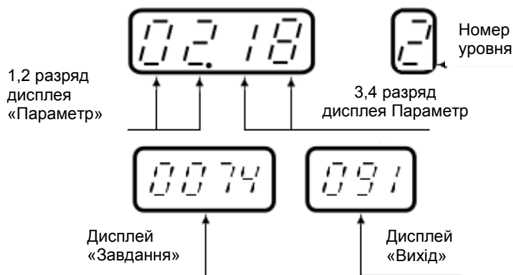
Рисунок 7.2 - Индикация параметров настройки в режиме программирования
