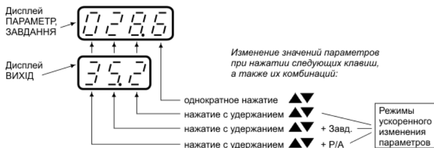
Рисунок 4.2 - Изменение значений на различных дисплеях
