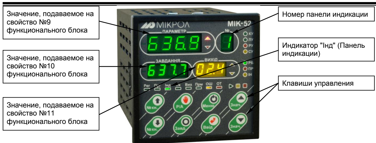
Рисунок 4.6 - Лицевая панель в режиме оперативного управления программным задатчиком
