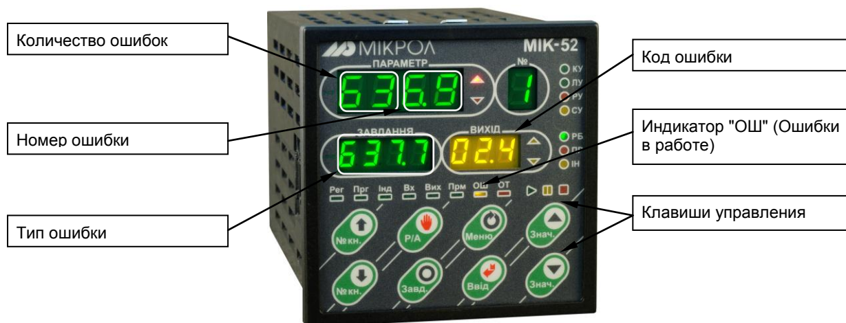
Рисунок 4.9 - Лицевая панель в режиме индикации ошибок
