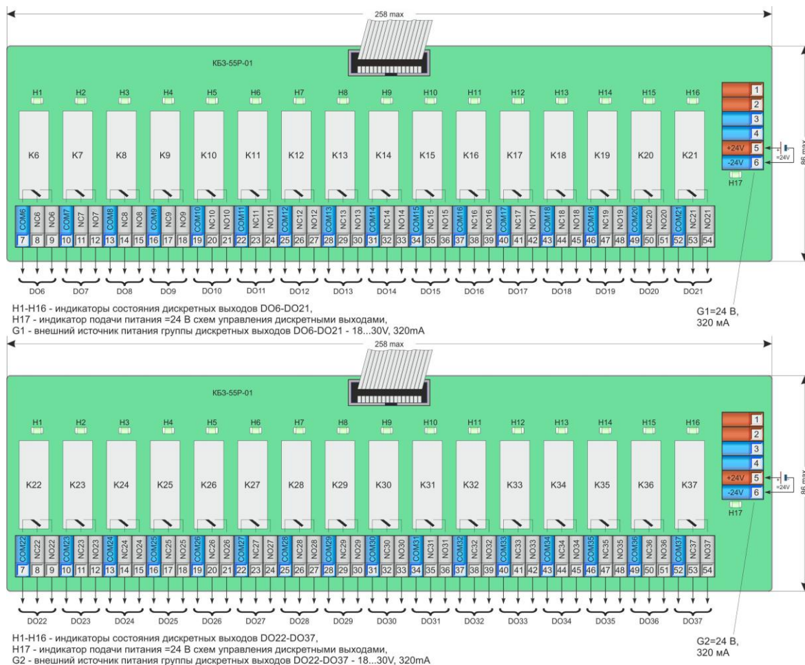
Рисунок 8.4.23 - Подключение сигналов модуля расширения МР-52-34 с помощью клеммно-блочного соединителя КБ3-55P-01 (два КБ3-54P-01)
