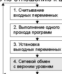
Рисунок 2.8 - Циклограмма работы контроллера
