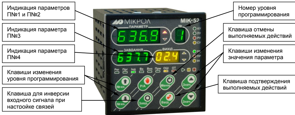
Рисунок 5.1 - Лицевая панель контроллера МИК-52 в режиме программирования
