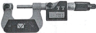
Рисунок А. 1 – Микрометр универсальный с цифровым отсчетным устройством МКУЦ(2)
