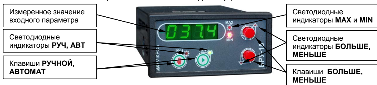
Рисунок 3.2 - Внешний вид блока ручного управления БРУ-15
