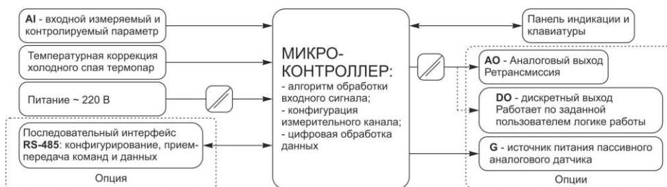
Рисунок 3.2 - Структурная схема индикатора ИТМ-100
