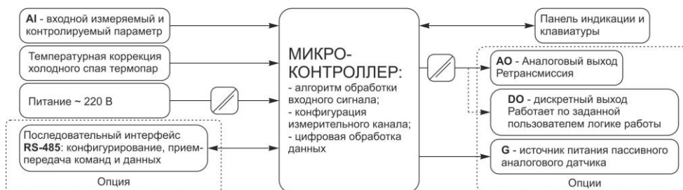
Рисунок 3.2 - Структурная схема индикатора ИТМ-101(В)
