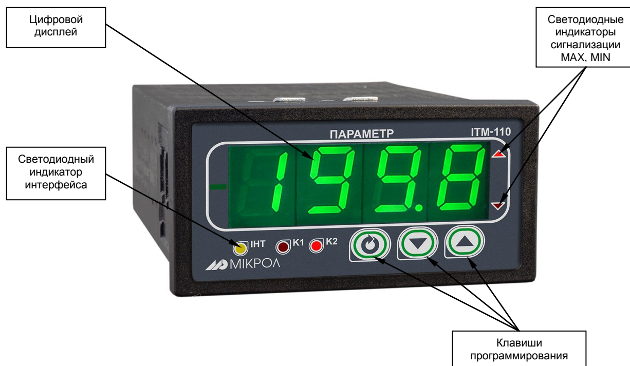
Рисунок 2.1 - Внешний вид передней панели индикатора ИТМ-110С
