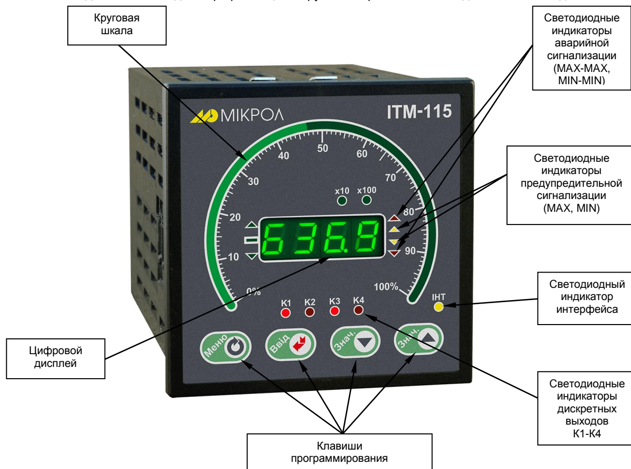
Рисунок 3.1 - Внешний вид передней панели индикатора ИТМ-115
