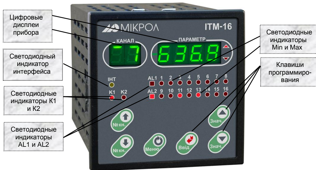
Рисунок 3.1 - Внешний вид передней панели индикатора ИТМ-16.
