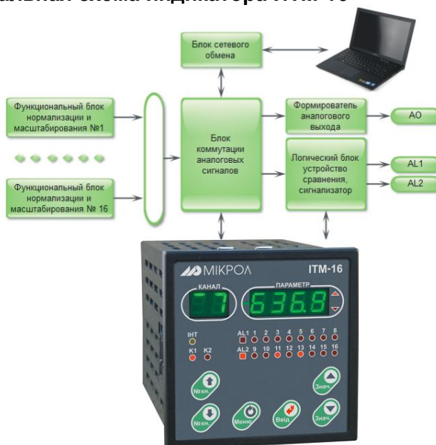
Рисунок 3.3 - Функциональная схема индикатора ИТМ-16
