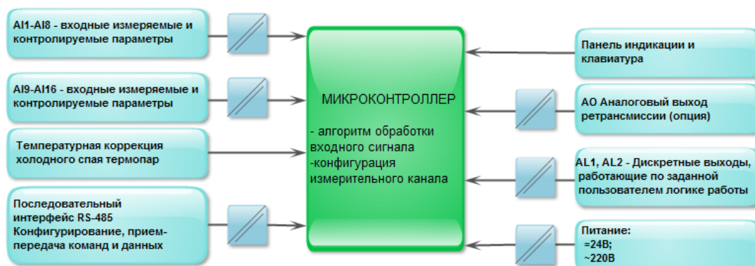
Рисунок 3.2 - Структурная схема индикатора ИТМ-16
