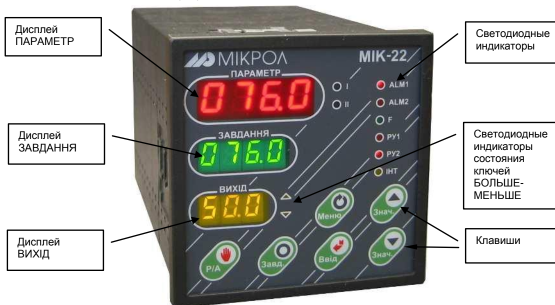
Рисунок 5.1 - Внешний вид передней панели регулятора МИК-22
