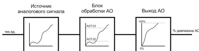
Рисунок 3.6 – Работа блока аналогового вывода в режиме ретрансмиссии
