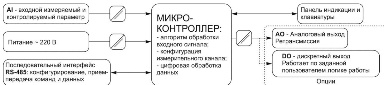
Рисунок 3.2 - Структурная схема вольтметра ИПМ-2
