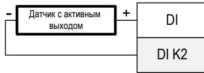
Подключение датчиков с активным выходом в режиме «Потенциальный вход»
